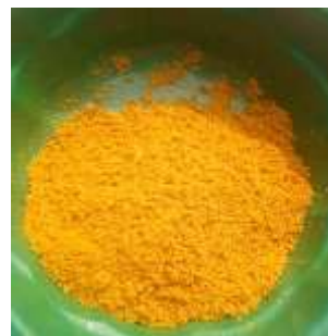
Gambar 3.34 Proses Pengeringan Serbuk dan Serat Bambu Betung g) Serbuk dan serat bambu yang sudah kering kemudian dioven selama 1 jam pada temperatur 100^{\circ} yang bertujuan untuk menghilangkan kadar air pada bambu tersebut.
