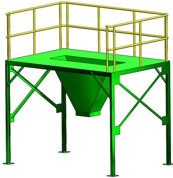
Gambar 4.5 Platform untuk mesin filter press
