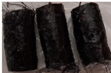
Gambar B.12 Sampel Uji Tekan C
