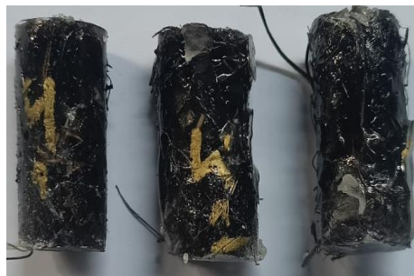
Gambar B.17 Sampel Uji Tekan H
