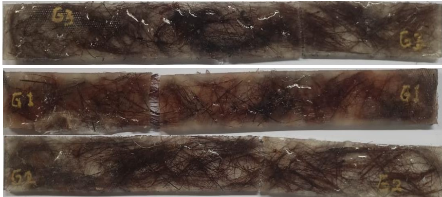
Gambar B.7 Sampel Uji Tarik G
