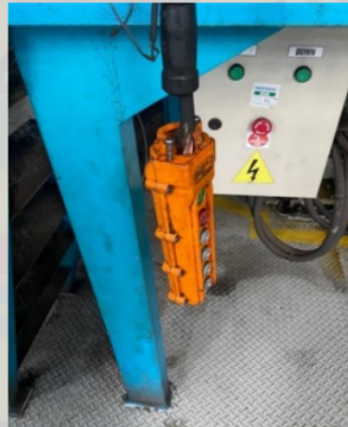
Gambar 6. Penggunaan Remote Control Crane Alat Pengangkat Drum
