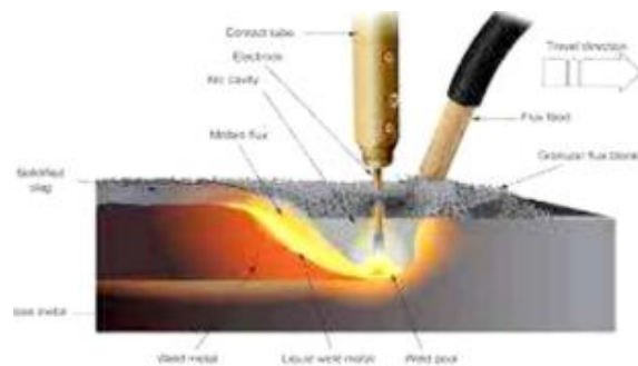
Gambar 3.11 Prinsip Kerja Las SAW
