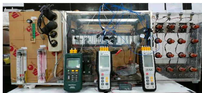
Gambar 3.3 Alat Eksperimen Sistem Pendingin Baterai
