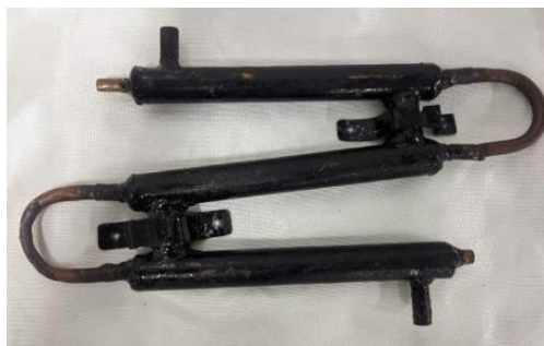
Gambar 4.24 Radiator Pada Alat Eksperimen Pendinginan Modul Baterai
