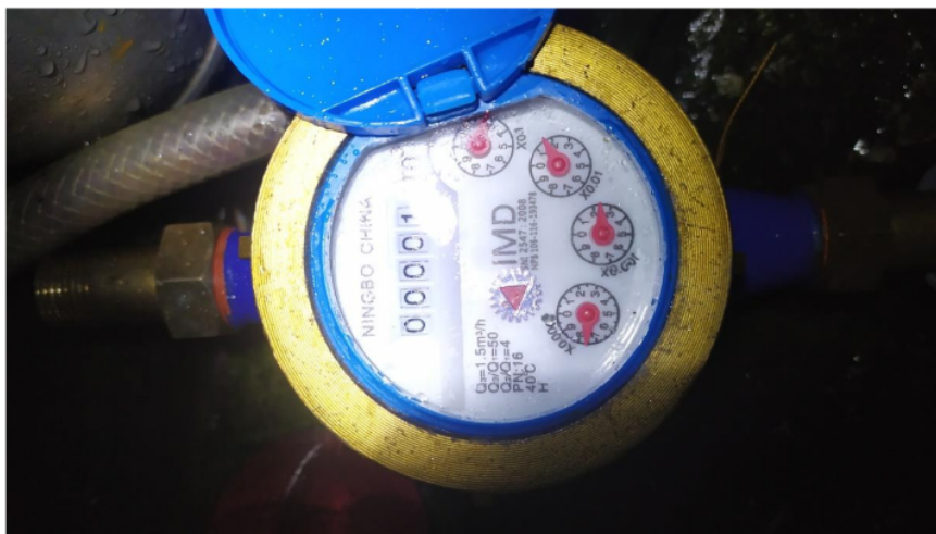
Gambar 3 Tampilan Kondisi Awal Meteran Konvensional Saat Kalibrasi
