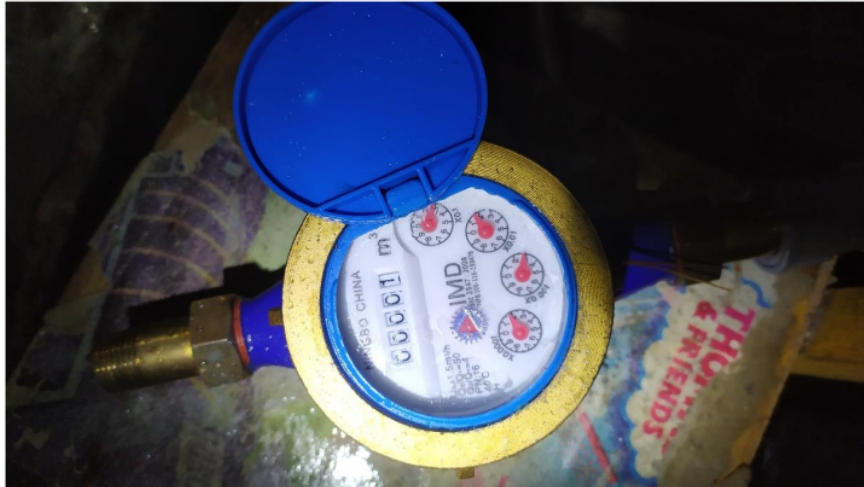
Gambar 4 Tampilan Kondisi Akhir Meteran Konvensional Saat Kalibrasi
