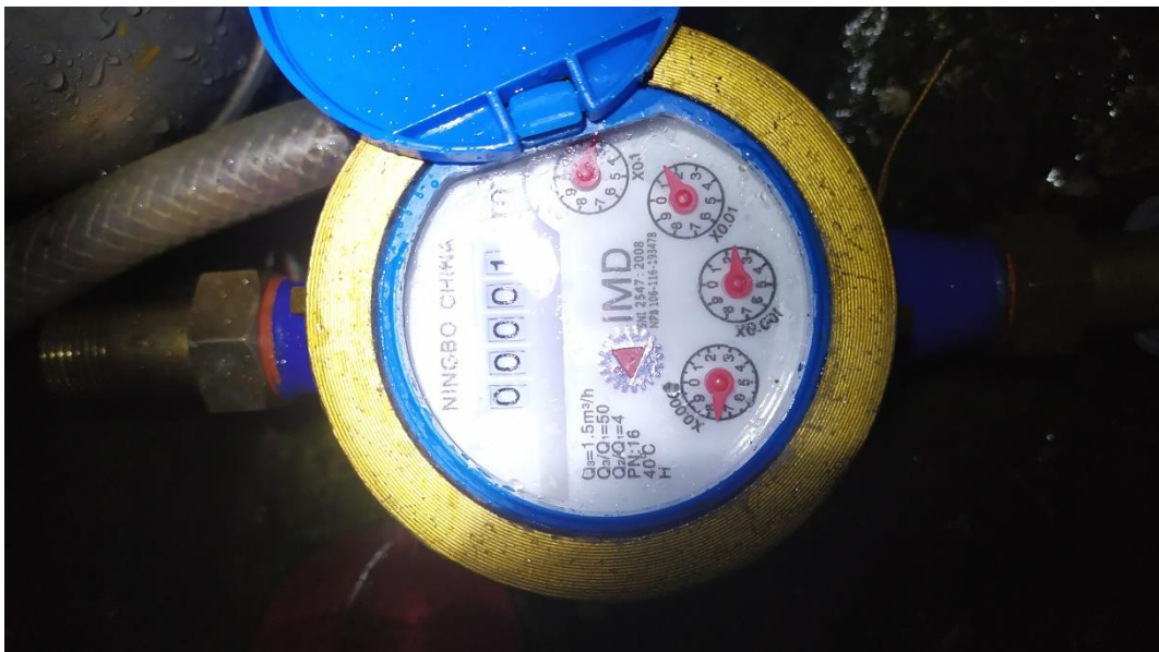
Gambar 3 Tampilan Kondisi Awal Meteran Konvensional Saat Kalibrasi
