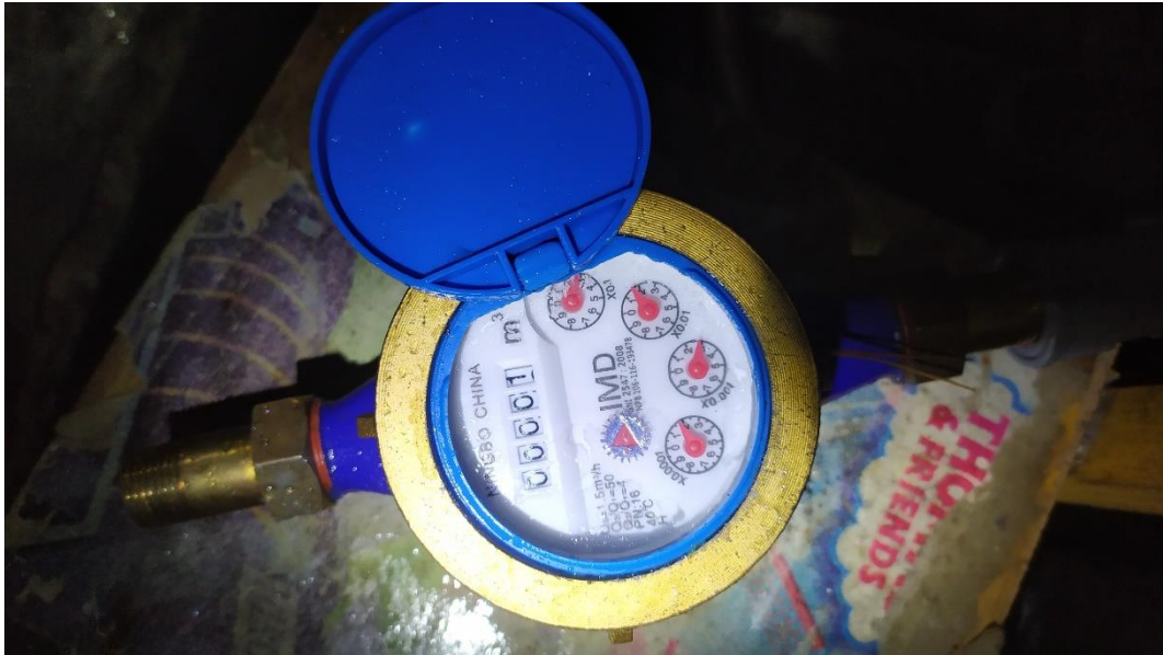
Gambar 4 Tampilan Kondisi Akhir Meteran Konvensional Saat Kalibrasi
