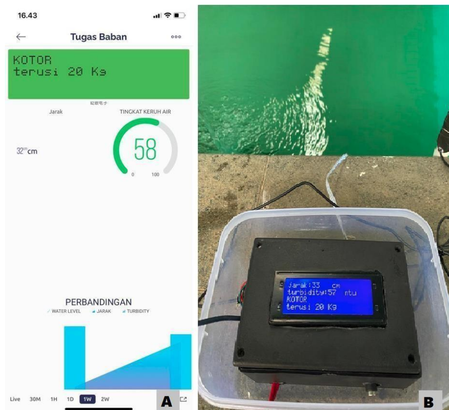
Gambar 4.8 Hasil Pemantauan Kekeruhan dan Tingkat Air di Kolam Renang Nurul Fikri (A) Pada Blynk (B) Pada Alat Penelitian
