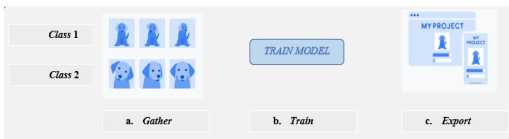
Gambar 2.6 Proses Menggunakan Teachable Machine, (a) Gather mengumpulkan data, (b) Train memproses data, (c) Export mengekstrak data
