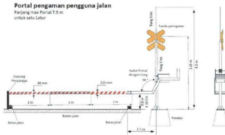
Gambar 3.4 Portal Pengaman Pengguna Jalan
