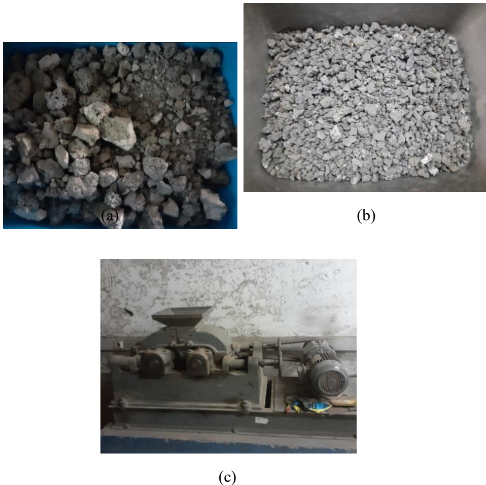
Gambar 3.4 Sampel Steel slag (a) sebelum proses crushing (b) setelah proses crushing (c) Roll Crusher
