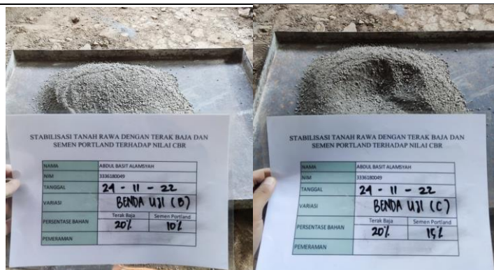
Tarah rawa yang sudah dicampurkan terak baja dan semen portland
