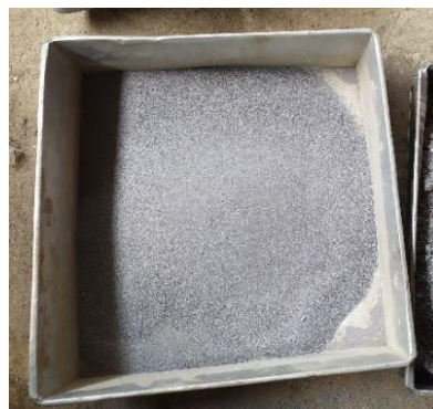
Gambar 5.3 Terak baja lolos saringan No.40 (Sumber : Dokumentasi penulis 2023)
