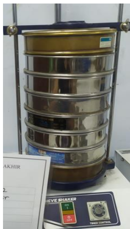
Gambar 5.10 Pengujian Besar Butir Tanah Rawa
