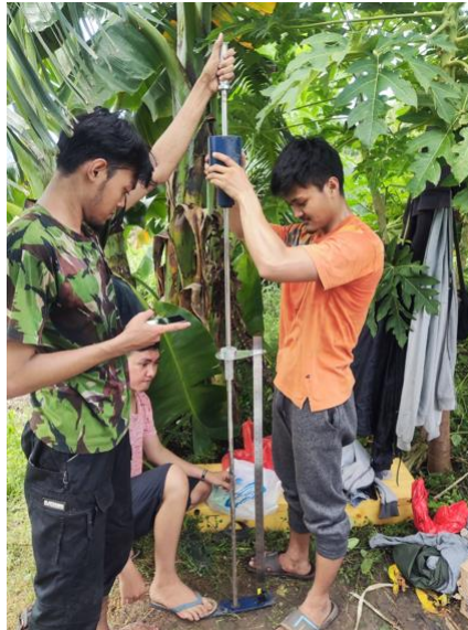
Gambar 5.13 Pengujian DCP Pada Loksai Tanah Rawa
