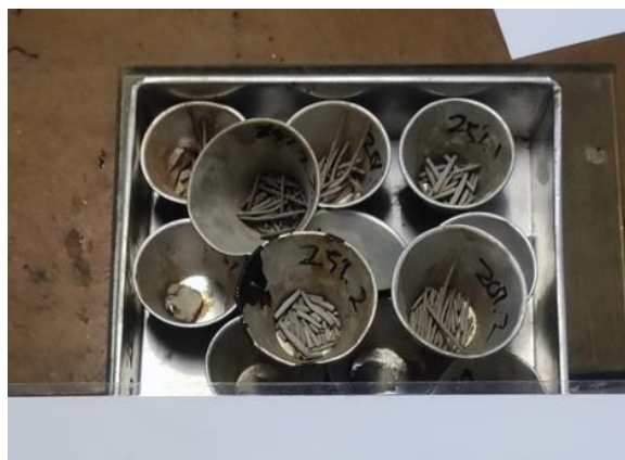
Gambar 5.9 Benda Uji Batas Plastis Tanah Rawa Setelah Di Oven
