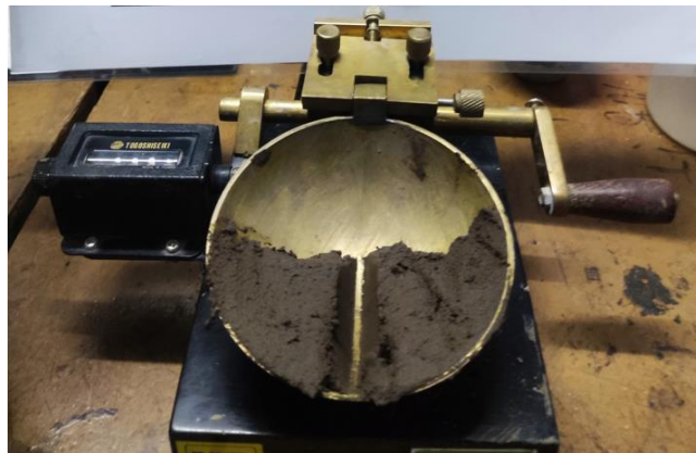
Gambar 5.6 Pengujian Tanah Rawa Untuk Mengetahui Batas Cair (Sumber : Dokumentasi penulis, 2023)
