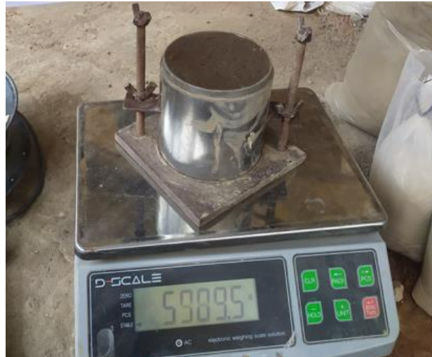
Gambar 5.11 Benda Uji Pemadatan Tanah Rawa (Sumber : Dokumentasi penulis, 2023)
