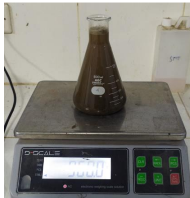
Gambar 5.5 Pengujian Berat Jenis Tanah Rawa (Sumber : Dokumentasi penulis 2023)
