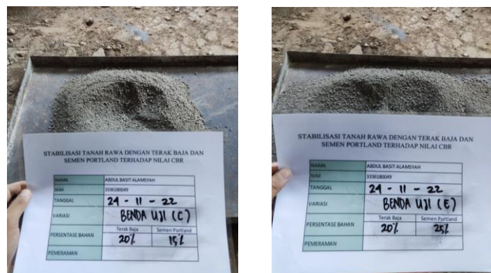
Gambar 5.18 Tanah Rawa Yang Sudah Dicampur Bahan Tambah Untuk Sampel CBR
