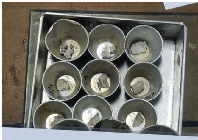
Gambar 5.7 Sampel Uji Batas Cair Tanah Rawa Setelah Di Oven (Sumber : Dokumentasi penulis, 2023)
