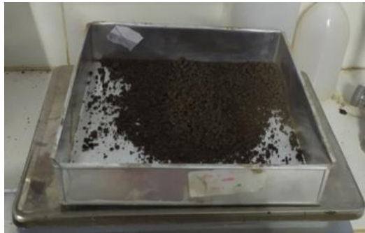
Gambar 5.4 Sampel Tanah Rawa untuk Uji Kadar Air (Sumber : Dokumentasi penulis 2023)
