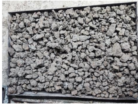
Gambar 5.2 Tanah Asli Setelah di Oven (Sumber : Dokumentasi penulis 2023)
