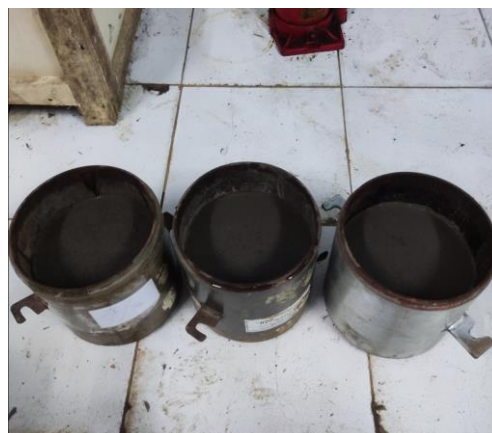
Gambar 5.19 Sampel CBR tanah rawa yang akan di peram menggunakan plasrik
