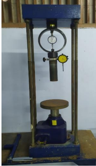
Gambar 3.4 Alat pengujian CBR Laboratorium (Sumber: Dokumen Penulis 2023)
