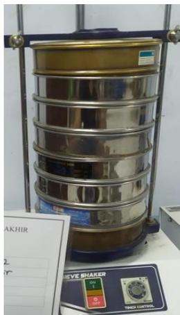
Gambar 5.10 Pengujian Besar Butir Tanah Rawa
