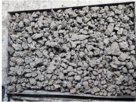
Gambar 5.2 Tanah Asli Setelah di Oven
