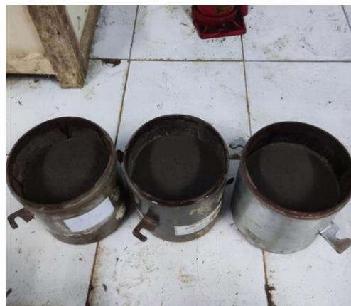
Gambar 5.19 Sampel CBR tanah rawa yang akan di peram menggunakan plastik
