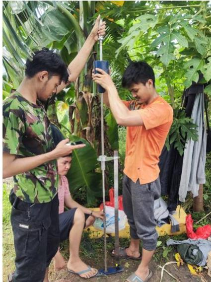
Gambar 5.13 Pengujian DCP Pada Loksai Tanah Rawa
