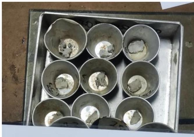
Gambar 5.7 Sampel Uji Batas Cair Tanah Rawa Setelah Di Oven
