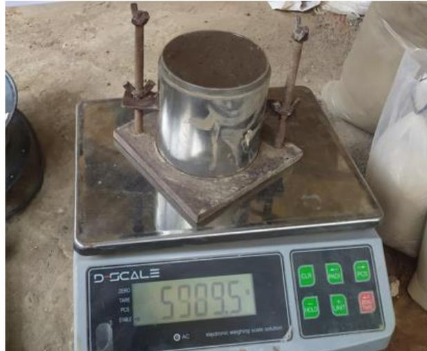
Gambar 5.11 Benda Uji Pemadatan Tanah Rawa
