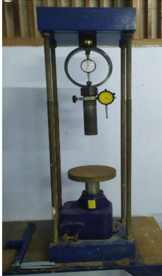
Gambar 3.4 Alat pengujian CBR Laboratorium
