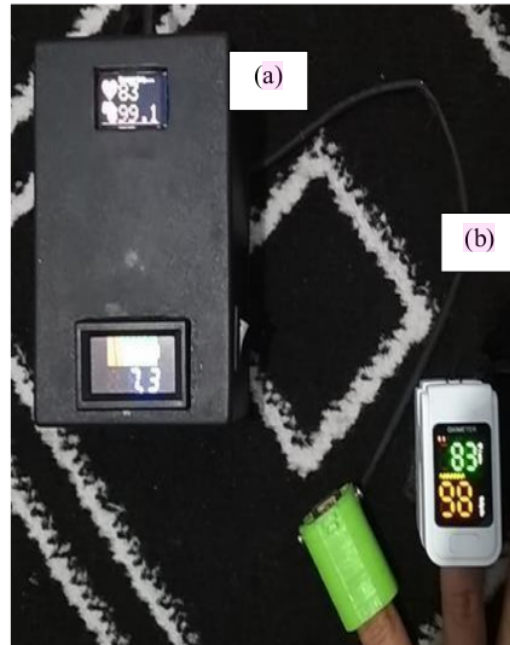
Gambar 4.5 Pengujian Alat yang Sudah dirancang (a) Pulse Oximeter SO811 (b)
