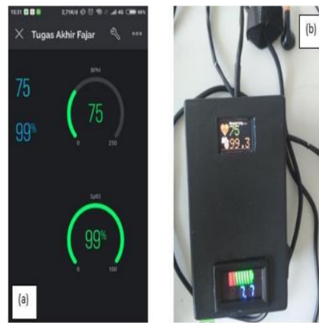
Gambar 4.11 Pengukuran Sistem Pemantauan Saturasi Oksigen (SpO 2 ) dan Detak Jantung (BPM) (a) Pada Blynk dan (b) Alat Penelitian.
