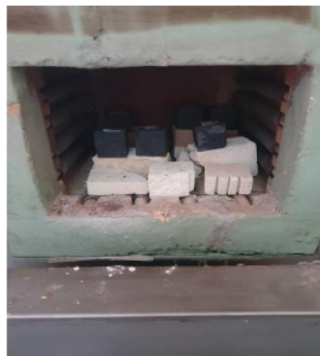
Gambar 3.6 Proses Pemanasan 900^{\circ}\text{C}
