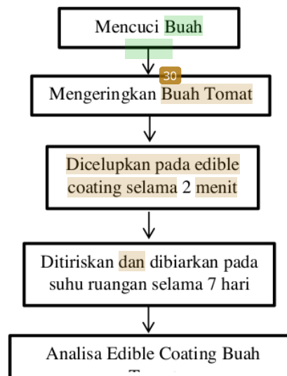
Gambar 3.8 Diagram Alir Pengaplikasian Edible Coating pada Buah Tomat
