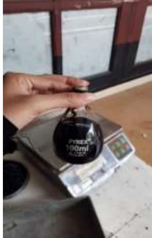
Gambar 5.8 Pengujian Berat Jenis Aspal (Sumber: Qurrotul Milania, 2023)
