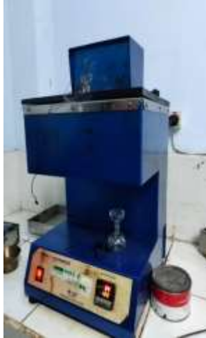
Gambar 5.13 Pengujian Viskositas Aspal (Sumber: Qurrotul Milania, 2023)
