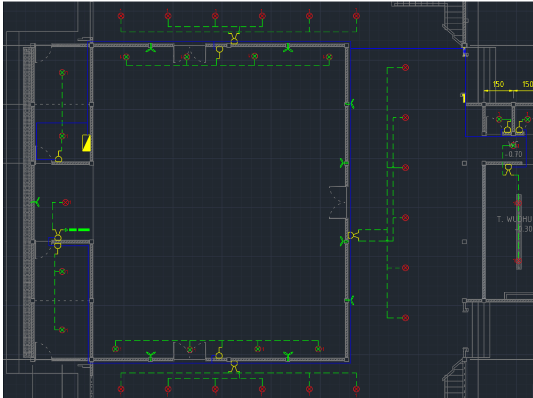
Gambar 4.2 Jalur Penerangan Lantai 1
