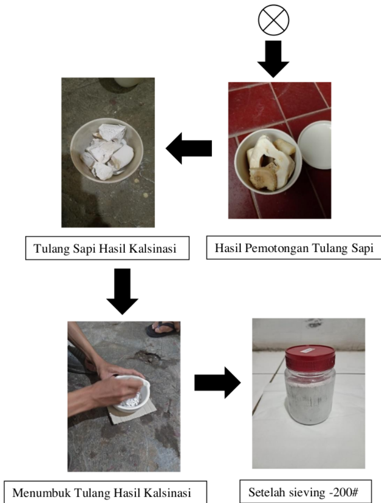
Gambar 3.5 Skematik Kalsinasi Limbah Tulang Sapi
