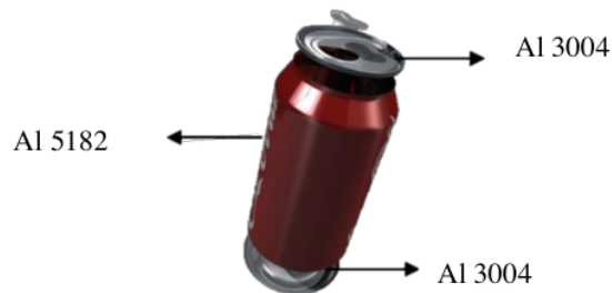
Gambar 2.13 Seri Penyusun Aluminium Bagian Komponen Kaleng
