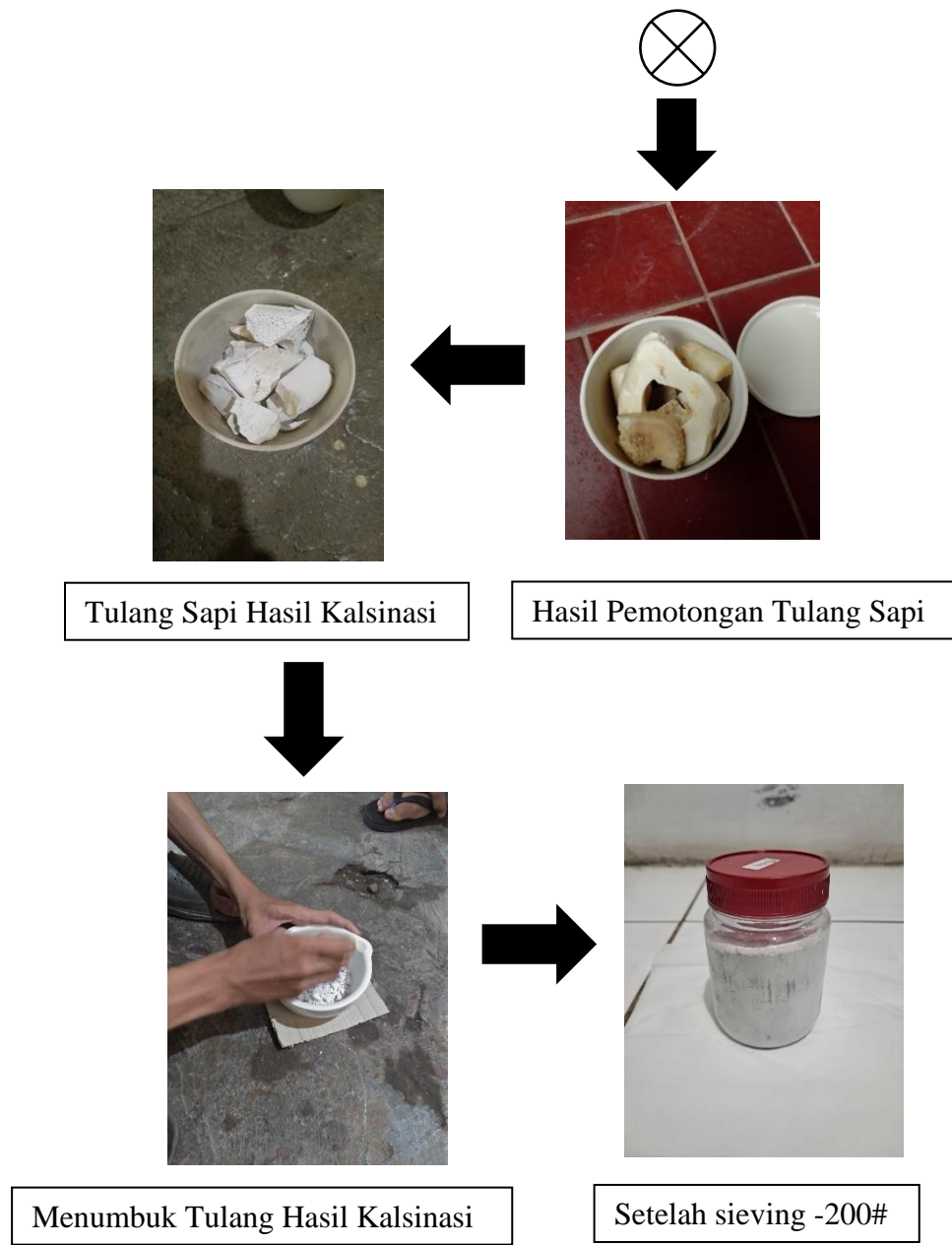
Gambar 3.5 Skematik Kalsinasi Limbah Tulang Sapi
