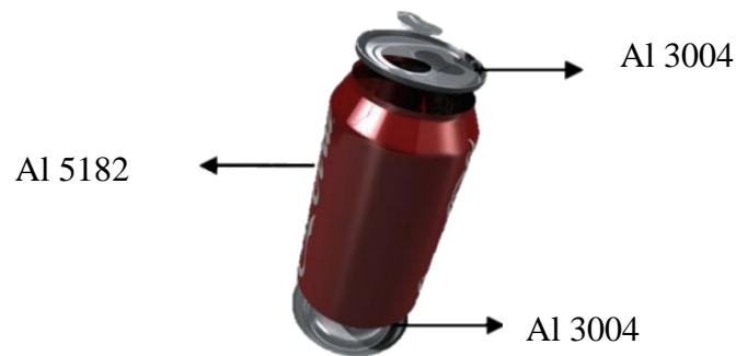
Gambar 2.13 Seri Penyusun Aluminium Bagian Komponen Kaleng
