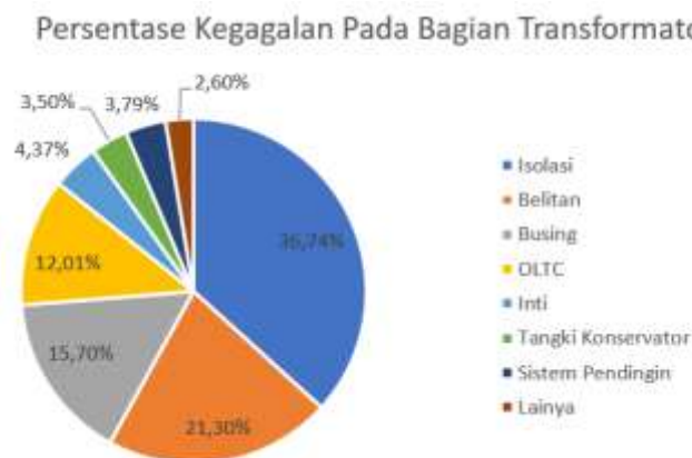
Gambar 2. 2 Persentase Temuan Kegagalan Transformator [19]
