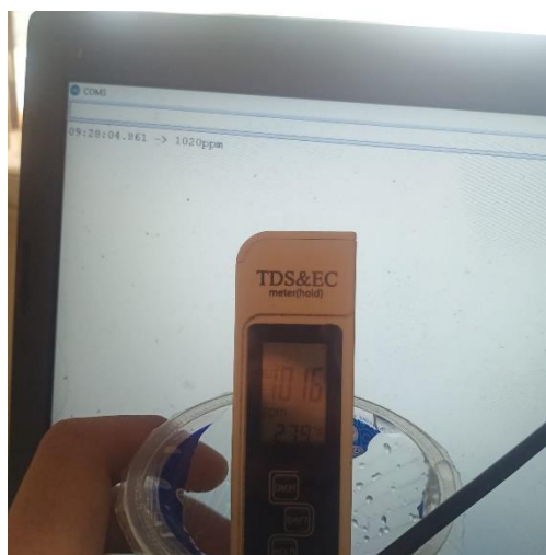
Gambar 4.2 Pengujian Sensor TDS dan TDS Meter
