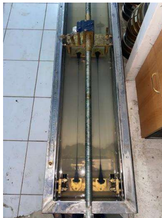
Gambar 4.4 Pemeriksaan Daktilitas Aspal
