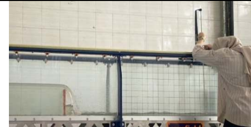
Gambar L-4.3. 24 Pengukuran tinggi muka air di hilir(Y) –Kondisi Pintu Tertutup
