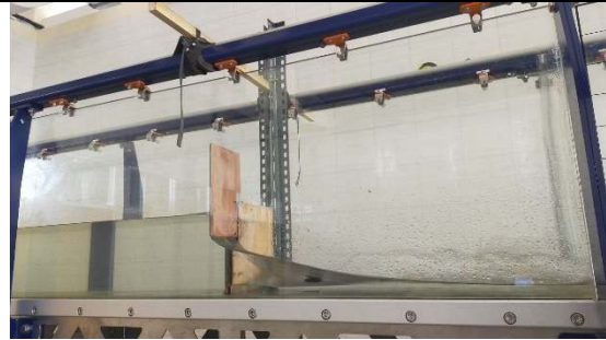
Gambar L-4.4. 25 Aliran di Sekitar Pintu Saat Tinggi Buka a = 13 cm –Kondisi Pintu Terbuka
