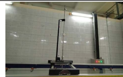
Gambar L-4.1. 9 Pemasangan Point Gauge
