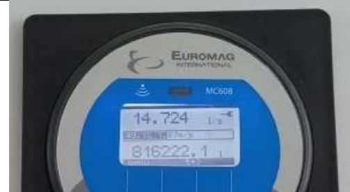
Gambar L-4.3. 9 Pembacaan Q_a = 14,724 l/s Putaran Pompa 5,0 –Kondisi Pintu Tertutup
