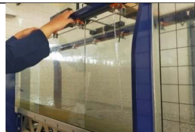
Gambar L-4.2. 8 Pengukuran Kedalaman Air di Hulu ( H ) dengan Point Gauge
