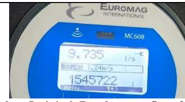
Gambar L-4.4. 6 Pembacaan Q_a = 9,735 l/s Tinggi bukaan 10cm –Kondisi Pintu Terbuka
