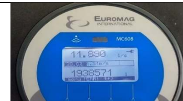
Gambar L-4.2. 6 Pembacaan Q_a = 11,89 l/s Putaran Pompa 4,20 –Kalibrasi Pipa Pitot
