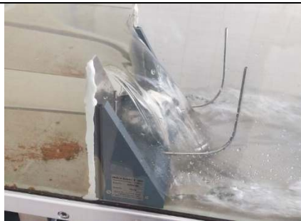
Gambar L-4.1. 32 Aliran Melalui Thompson
