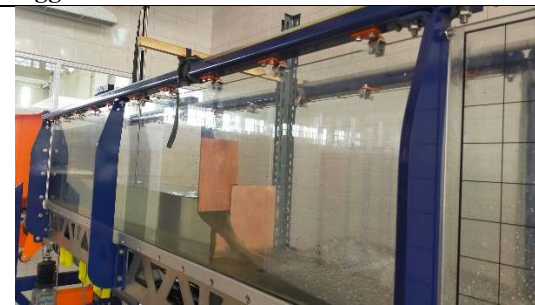
Gambar L-4.4. 23 Aliran di Sekitar Pintu Saat Tinggi Bukaan a = 12 cm –Kondisi Pintu Terbuka
