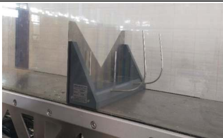
Gambar L-4.1. 8 Peluap Thompson di Saluran
