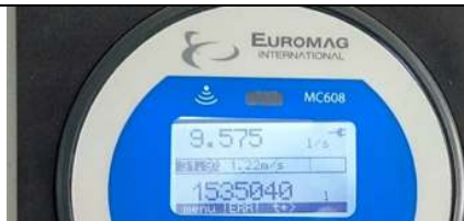
Gambar L-4.4. 5 Pembacaan Q_a = 9,575 l/s Tinggi bukaan 9cm –Kondisi Pintu Terbuka
