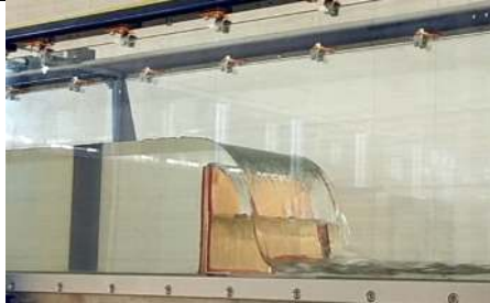
Gambar L-4.3. 16 Tinggi Peluapan Air Putaran Pompa 4,0 –Kondisi Pintu Tertutup
