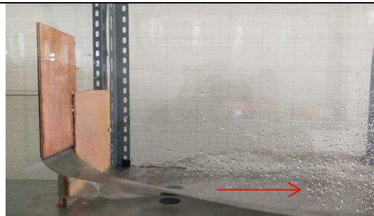
Gambar L-4.4. 20 Aliran di Sekitar Pintu Saat Tinggi Bukaan a = 10 cm –Kondisi Pintu Terbuka
