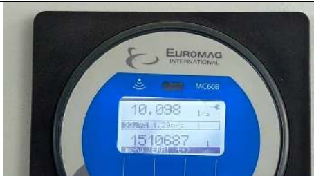
Gambar L-4.4. 16 Pembacaan Q_a = 10,098 l/s Tinggi bukaan 13cm –Kondisi Pintu Terbuka
