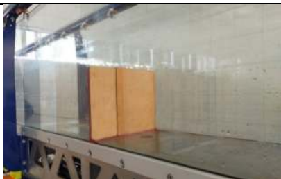
Gambar L-4.3. 1 Pemasangan Pintu Air Pada Kondisi Pintu ditutup
