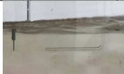
Gambar L-4.3. 26 Penempatan Pipa Pitot Saat Mengukur Aliran –Kondisi Pintu Tertutup
