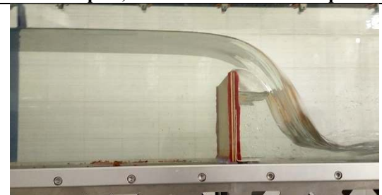
Gambar L-4.3. 19 Tinggi Peluapan Air Putaran Pompa 5,5 –Kondisi Pintu Tertutup
