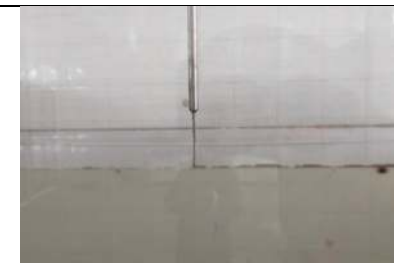
Gambar L-4.2. 9 Posisi Point Gauge Ketika Pengukuran Tinggi Muka Air di Hulu ( H )
