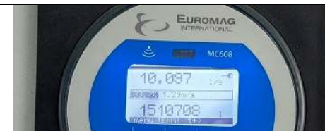
Gambar L-4.4. 15 Pembacaan Q_a = 10,097 l/s Tinggi bukaan 13cm –Kondisi Pintu Terbuka
