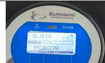
Gambar L-4.4. 9 Pembacaan Q_a = 9,914 l/s Tinggi bukaan 11cm –Kondisi Pintu Terbuka
