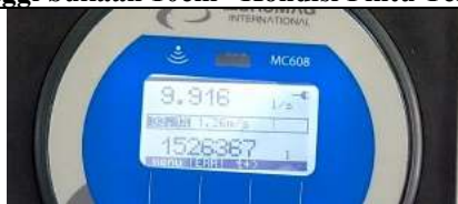
Gambar L-4.4. 11 Pembacaan Q_a = 9,916 l/s Tinggi bukaan 11cm –Kondisi Pintu Terbuka
