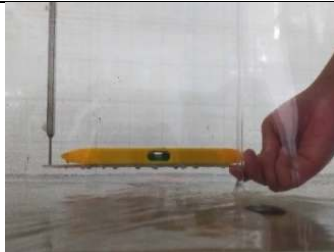
Gambar L-4.3. 25 Pengukuran EL2 di hulu – Kondisi Pintu Tertutup
