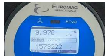
Gambar L-4.4. 14 Pembacaan Q_a = 9,970 l/s Tinggi bukaan 12cm –Kondisi Pintu Terbuka
