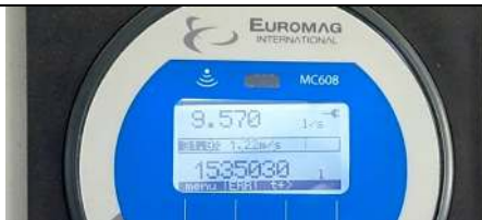
Gambar L-4.4. 4 Pembacaan Q_a = 9,570 l/s Tinggi bukaan 9cm –Kondisi Pintu Terbuka
