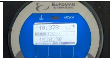
Gambar L-4.2. 5 Pembacaan Q_a = 10,38 l/s Putaran Pompa 3,95 –Kalibrasi Pipa Pitot
