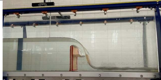
Gambar L-4.3. 17 Tinggi Peluapan Air Putaran Pompa 4,5 –Kondisi Pintu Tertutup
