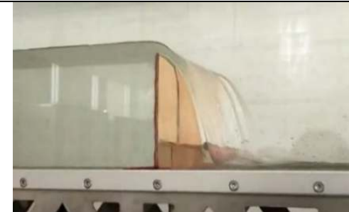
Gambar L-4.3. 15 Pelimpahan Air Pada Pintu Air dan Pelimpah –Kondisi Pintu Tertutup
