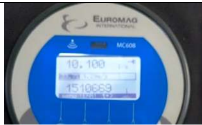
Gambar L-4.4. 17 Pembacaan Q_a = 10,100 l/s Tinggi bukaan 13cm –Kondisi Pintu Terbuka
