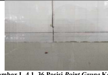
Gambar L-4.1. 36 Posisi Point Gauge Ketika Pengukuran Tinggi Muka Air di Hulu ( H )
