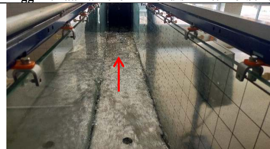
Gambar L-4.4. 22 Aliran Di Hilir Akibat Bukaan Pintu –Kondisi Pintu Terbuka
