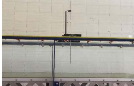
Gambar L-4.2. 1 Pemasangan Point Gauge di Saluran
