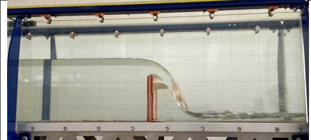
Gambar L-4.3. 18 Tinggi Peluapan Air Putaran Pompa 5,0 –Kondisi Pintu Tertutup
