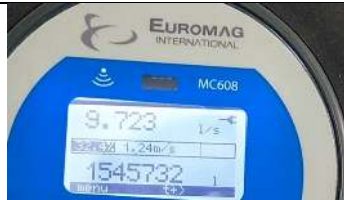
Gambar L-4.4. 7 Pembacaan Q_a = 9,723 l/s Tinggi bukaan 10cm –Kondisi Pintu Terbuka
