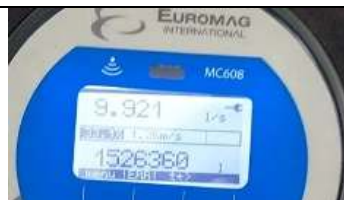
Gambar L-4.4. 10 Pembacaan Q_a = 9,921 l/s Tinggi bukaan 11cm –Kondisi Pintu Terbuka
