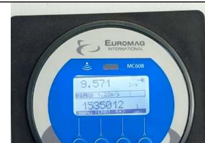
Gambar L-4.4. 3 Pembacaan Q_a = 9,571 l/s Tinggi bukaan 9cm –Kondisi Pintu Terbuka
