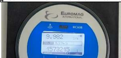
Gambar L-4.4. 13 Pembacaan Q_a = 9,982 l/s Tinggi bukaan 12cm –Kondisi Pintu Terbuka
