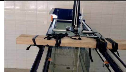
Gambar L-4.2. 15 Kayu Penyangga Pipa Pitot
