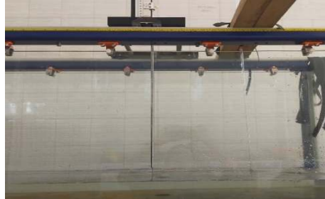
Gambar L-4.2. 2 Pemasangan Pipa Pitot di Saluran
