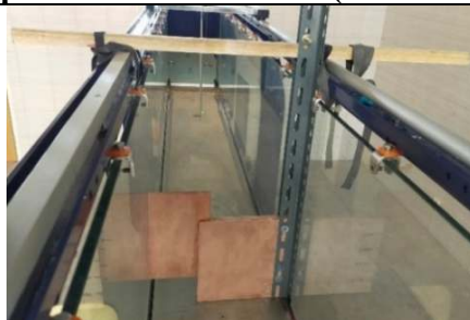
Gambar L-4.4. 1 Pemasangan Pintu Air (Tampak Depan)- Kondisi Pintu Terbuka
