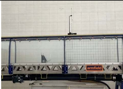
Gambar L-4.1. 10 Posisi Peluap Thompson dan Point Gauge di Saluran
