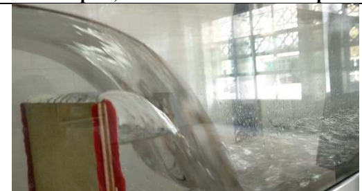
Gambar L-4.3. 21 Tinggi Peluapan Air Putaran Pompa 5,5 –Kondisi Pintu Tertutup
