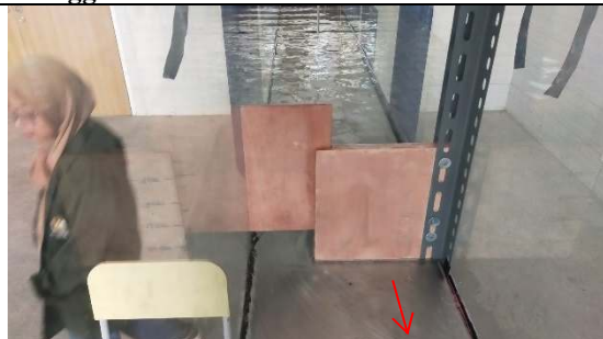
Gambar L-4.4. 19 Aliran di Sekitar Pintu Saat Tinggi Bukaan a = 9 cm –Kondisi Pintu Terbuka
