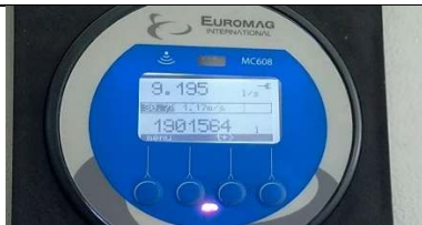
Gambar L-4.2. 4 Pembacaan Q_a = 9,19 l/s Putaran Pompa 3,70 –Kalibrasi Pipa Pitot
