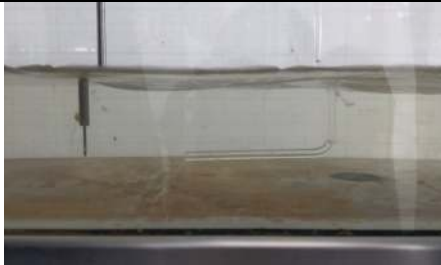
Gambar L-4.2. 10 Penempatan Point Gauge dan Pipa Pitot di Kedalaman 0,6H
