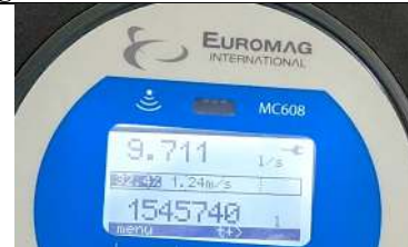
Gambar L-4.4. 8 Pembacaan Q_a = 9,711 l/s Tinggi bukaan 10cm –Kondisi Pintu Terbuka
