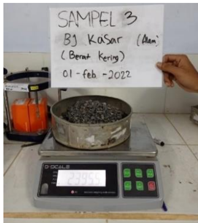
Gambar 5.1 Pengujian Berat Jenis Agregat Kasar Alam
