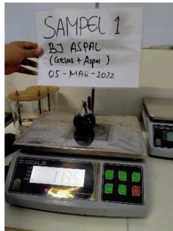
Gambar 5.9 Pengujian Berat Jenis Aspal
