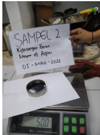
Gambar 5.8 Pengujian Kehilangan Berat
