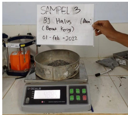
Gambar 5.3 Pengujian Berat Jenis Agregat Halus Alam
