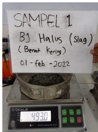
Gambar 5.4 Pengujian Berat Jenis Agregat Halus Terak Nikel
