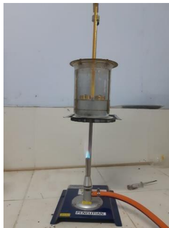
Gambar 5.10 Pengujian Titik Lembek
