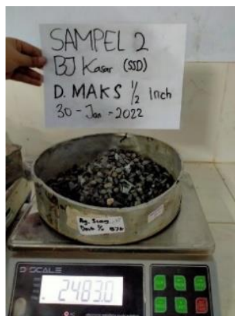
Gambar 5.2 Pengujian Berat Jenis Agregat Kasar Terak Nikel
