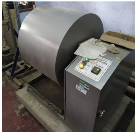
Gambar 5.5 Pengujian Keausan Dengan Menggunakan Mesin LAA Agregat Alam
