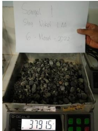
Gambar 5.6 Pengujian Keausan Dengan Menggunakan Mesin LAA Agregat Terak Nikel
