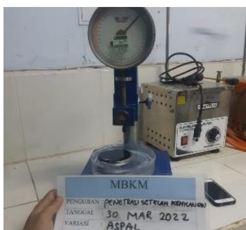
Gambar 5.7 Pengujian Penetrasi Aspal
