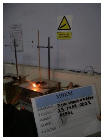
Gambar 5.11 Pengujian Titik Nyala dan Titik Bakar
