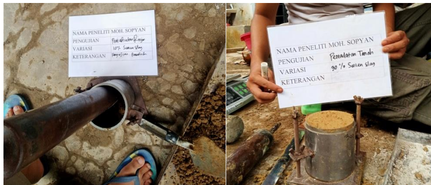
Gambar 5.10 Pengujian Pemadatan Tanah
