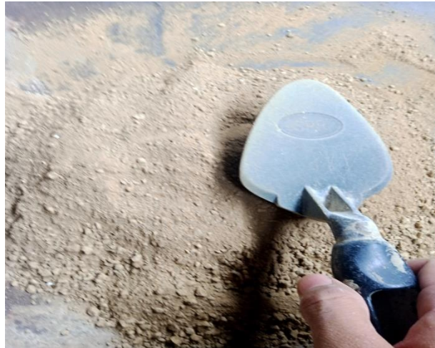
Gambar 5.2 Sampel tanah ditumbuk setelah dikeringkan (Sumber : Dokumentasi Penulis, 2023)
