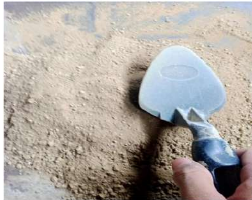
Gambar 5.2 Sampel tanah ditumbuk setelah dikeringkan (Sumber : Dokumentasi Penulis, 2023)
