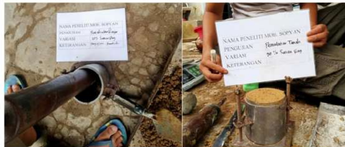
Gambar 5.10 Pengujian Pemadatan Tanah
