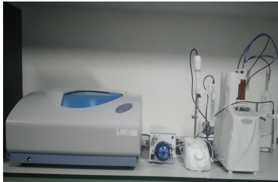
Gambar 3.9 Alat Pengujian PSA Pada Sampel
