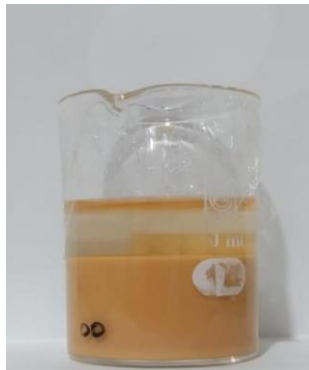
Gambar 3.5 Hasil Presipitasi Fe Menggunakan \text{H}_2\text{SO}_4
