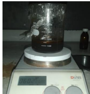
Gambar 3.3 Pelindian dengan Reagen Monosodium Glutamate
