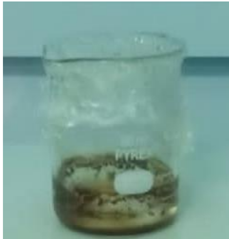
Gambar 4.7 Endapan Ni yang Mengendap Pada Dasar Wadah Saat Proses Sintesis 72 Jam Berlangsung
