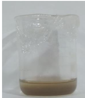
Gambar 3.6 Hasil Presipitasi Ni Menggunakan NaOH
