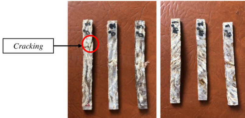
Gambar 4.11 Foto Spesimen Posisi Hasil Patahan Uji Bending
