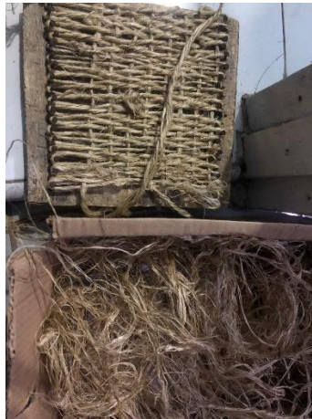
Gambar 3.18 Proses Tenun Serat Rami
