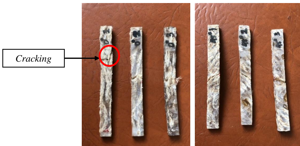
Gambar 4.20 Foto Spesimen Posisi Hasil Patahan Uji Bending
