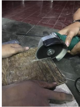
Gambar 3.22 Proses Pemotongan Spesimen
