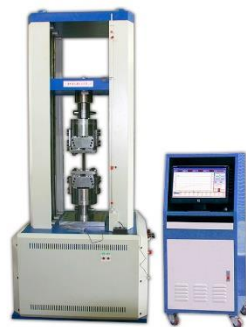
Gambar 3.12 Alat Uji Bending
