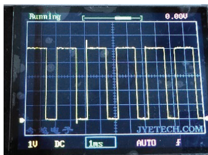
Gambar 12 Hasil Pengujian Pulse Width Modulation sebesar 165 atau 63%
