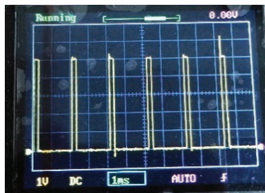
Gambar 3 Hasil Pengujian Pulse Width Modulation sebesar 30 atau 12%
