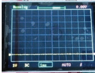
Gambar 1 Hasil Pengujian Pulse Width Modulation sebesar 0 atau 0%
