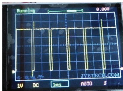
Gambar 16 Hasil Pengujian Pulse Width Modulation sebesar 225 atau 88%
