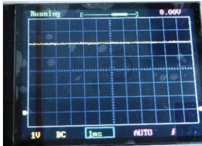
Gambar 18 Hasil Pengujian Pulse Width Modulation sebesar 255 atau 100%
