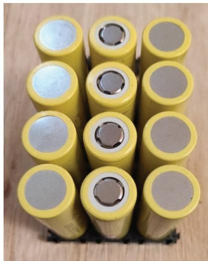
Gambar 3.5 Hasil Perancangan Modul Baterai *Pack* Li-Ion LG 18650HE4
