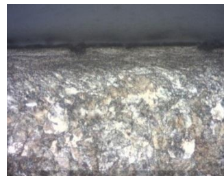
Gambar 11 Deformasi dibawah permukaan kontak rel
