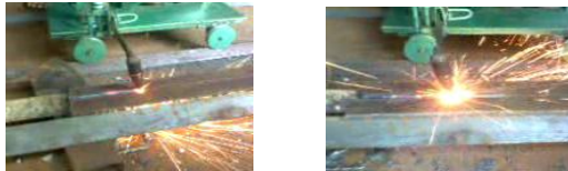
Gambar 3.6 Nyala api yang kurang baik pada waktu proses pemotongan plat
