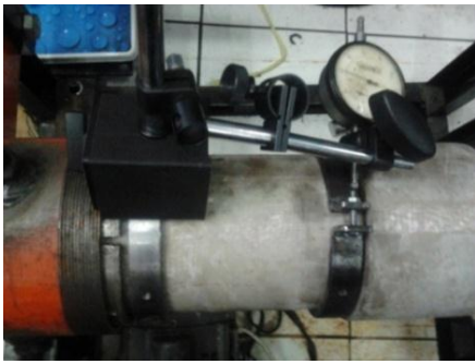
Gambar 14 Pengujian torsi terhadap pipa
