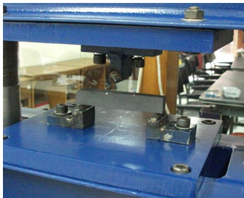
Gambar 6 Spesimen yang sedang diuji bending
