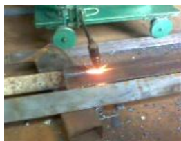
Gambar 3.1 Proses pemotongan plat semiotomatis
