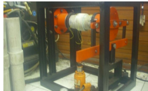
Gambar 8 Alat uji puntir untuk sambungan pipa komposit
