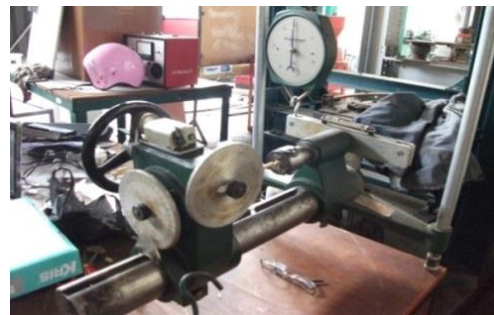
Gambar 12 Pengujian torsi untuk material adesif
