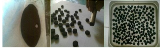
Gambar 3. Proses Pembuatan Pelet Arang dan Arang Teraktivasi
