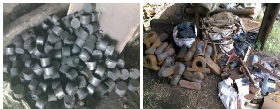
(a) Bahan Baku Pengecoran Logam (Briket Kokas Lokal Terbaik Hasil Penelitian dan Logam Bekas)
