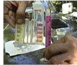
Gambar 3.3 analisis pH biodiesel dengan kertas lakmus
