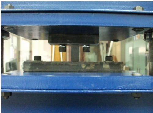
Gambar 5 Spesimen yang sedang diuji tekan
