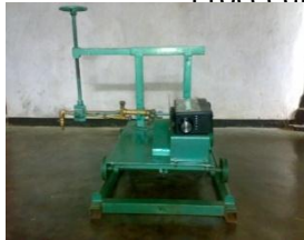
Gambar 2.1 Mesin potong plat semiotomatis
