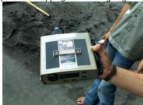
(d) Pyrometer Optik Untuk Mengukur Temperatur Logam Cair
