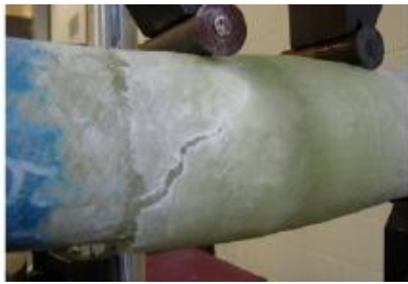
Gambar 2 Kegagalan sambungan dimulai dari bagian pinggir dan terus merambat ke bagian tengah (Peck J. A. dkk. (2007))
