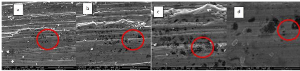
Gambar 3. Morfologi sampel 17-4 PH hasil SEM dengan pembesaran 2500x (a), 5000 x (b), 10.000x (c), dan 20.000x (d)
