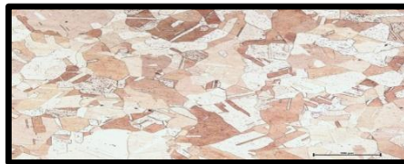
Gambar 2 Struktur mikro logam dasar tembaga (200x)
