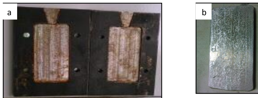
Gambar 1(a). Cetakan logam untuk pengecoran specimen. (b). Spesimen Hasil Pengecoran
