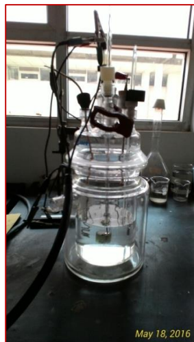
Gambar 1. Sel polarisasi dengan menggunakan 3 elektroda
