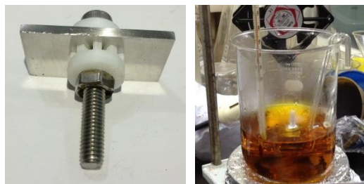
Gambar 1 foto instalasi crevice washer pada spesimen dan foto pengujian
