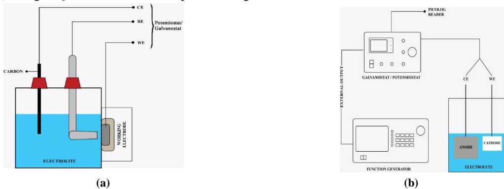
Gambar 1. Skema rangkain alat (a) polarisasi (b) pelapisan
