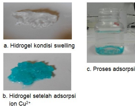
Gambar 3. Proses adsorpsi ion \text{Cu}^{2+} oleh HSA kopoli (asam akrilat-HEA)-kitosan.
