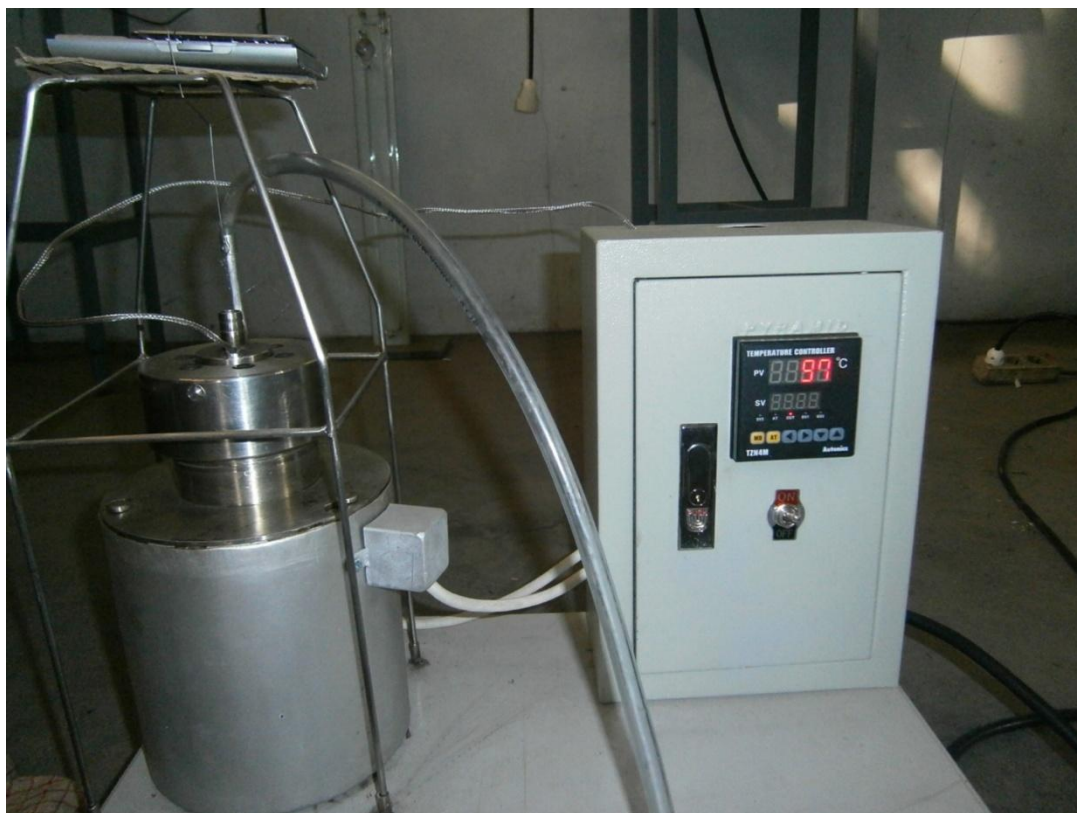
Gambar 2. Reaktor Torefaksi Dilengkapi dengan Timbangan dan Pengendali Temperatur
