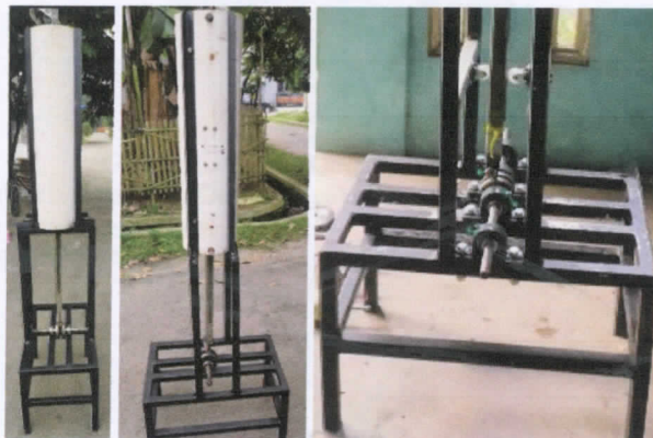
Gambar 3. Rangka Dudukan Generator
