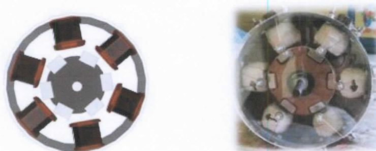
Gambar 4. Desain Gabungan Komponen Terpasang pada Generator Gerak Rotasi
