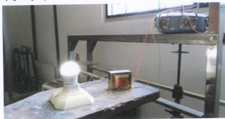
Gambar 8. Kerja gabungan generator AC gerak rotasi dan translasi menggunakan beban trafo dan lampu LHE 5 w.
