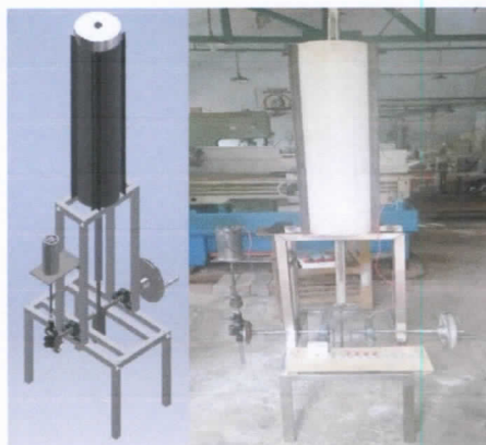
Gambar 5. Desain dan hasil pembuatan generator translasi dan rotasi arah gerak vertical
