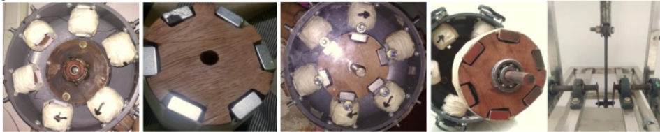
a. Lilitan kumparan stator b. Magnet rotor c. Rangkaian generator AC gerak rotasi d. Bantalan dan torak
