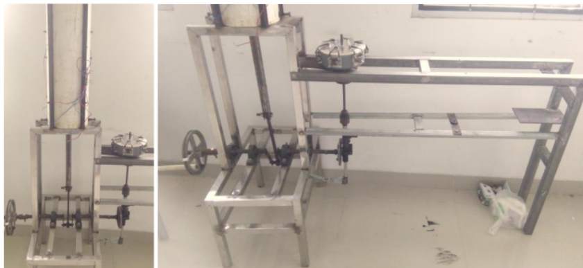
Gambar 4. Hasil pembuatan generator AC gerak translasi dan rotasi
