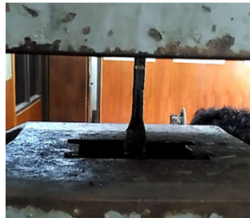
Gambar 7. Proses uji tarik material komposit karet
