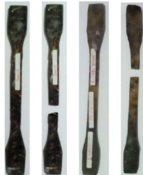
Gambar 8. Bentuk patahan material komposit
