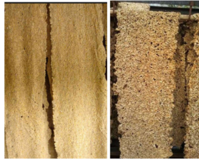
Gambar 1. Proses Pengeringan Karet Crepe dengan Cara Diangin-anginkan
