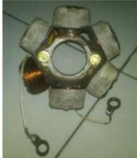
Gambar 1. Stator dan Dimensinya (mm).
