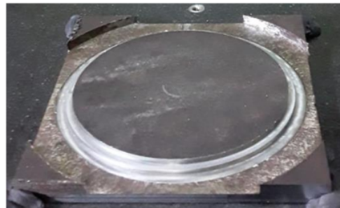
Gambar 4. Hasil Menggunakan Milling CNC Leadwell V-30
